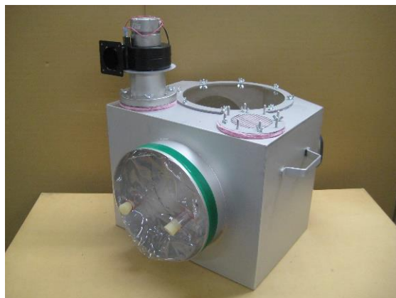
感染実験用ステンレス製アイソレータ (ステリールロック部)
