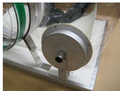
排気用フィルターユニット
