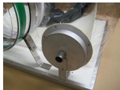
排気用フィルターユニット
