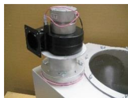
排気ブロワー部
