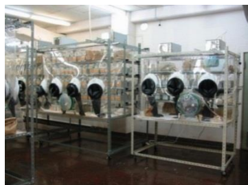
大型 / 中型ビニールアイソレータ JV-1100 JV-1600
