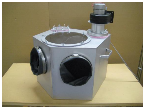
感染実験用ステンレス製アイソレータ (操作部)
